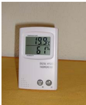
Feuchtigkeitsmesser (Hygrometer) zeigen die relative Luftfeuchte. Nach dem Lüften bei feuchtem Wetter in der Übergangszeit werden hier über 60% gemessen.
